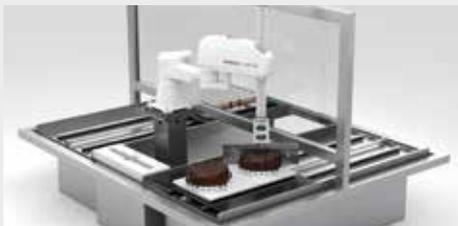
Caratteristiche tra cui il grado di protezione IP65, bulloni, soffietti resistenti alla corrosione e coperchio del soffietto rendono le Opzioni Ambientali di SR-12iA e SR-20iA ideali per applicazioni alimentari secondarie.
